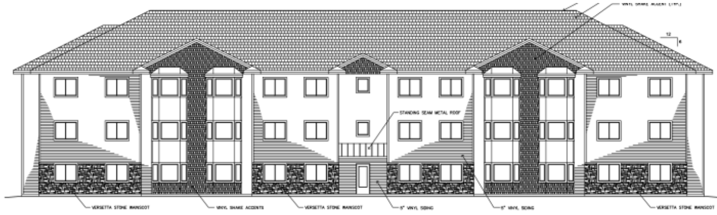
4 A6 WEST EXTERIOR ELEVATION 1/8" = 1'-0"
